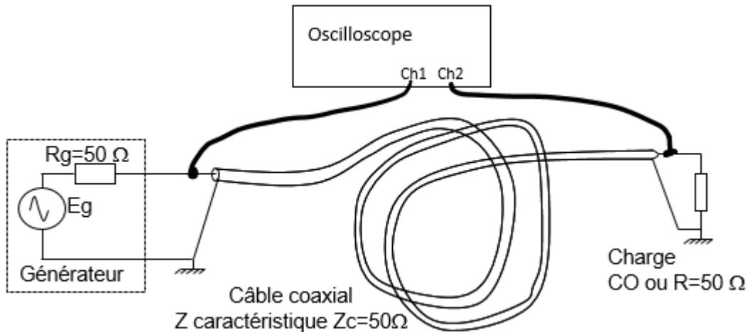
Observer l'entrée et la sortie du câble en vérifiant que les 2 voies Ch1 et Ch2 de l'oscilloscope sont commutées sur Hi\_Z.
