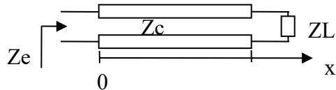
On peut démontrer que la tension et le courant le long de cette ligne de transmission s'expriment comme suit en fonction de la distance  $x$ .
