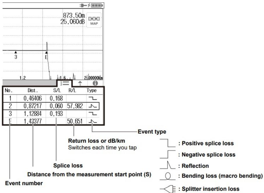
Il est possible d'utiliser le mode ZOOM pour étudier plus en détail une partie de la liaison en faisant un zoom avec 2 doigts, de placer de nouveau curseur (en cliquant sur la courbe, de la déplacer en le faisant glisser ou avec les flèches du menu.
