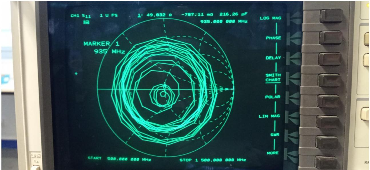
La fréquence la plus proche de  $50 \Omega$  est à 935 MHz.
