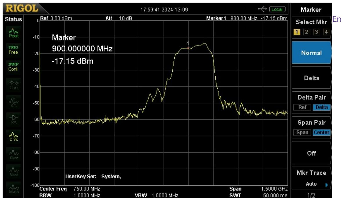
remplaçant le câble d'un mètre par celui de treize, nous trouvons une atténuation de  $-17,15$  dBm. On a donc une différence de  $-5,19$  dB. Le gain apporté par le câble est de 0,303.
